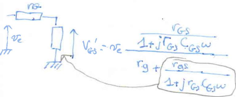
$$V_{gs}' = v_e \frac{r_{gs}}{r_g + r_{gs}} \cdot \frac{1}{1 + j r_g // r_{gs} C_{gs} \omega}$$
