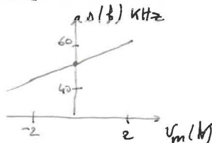
Si on met 20V, on obtient 55 kHz à 10V d'amplitude (2Vcc)
