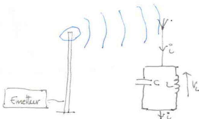
2) On suppose que  $i = I \cos(2\pi f t)$ , avec  $f = 220 \text{ kHz}$  et la capacité  $C = 410 \text{ pF}$ . Pour avoir  $\theta \max$  il suffit que le dénominateur soit à 0.
