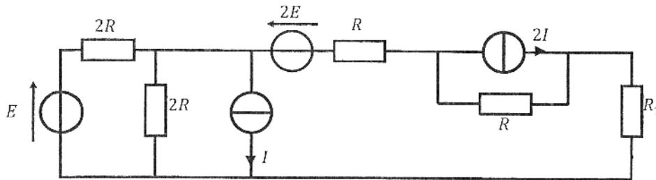
En utilisant la méthode de votre choix, déterminer l'expression de la tension aux bornes de la résistance  $R_1$  en fonction de  $E$ ,  $I$ ,  $R$  et  $R_1$ .
