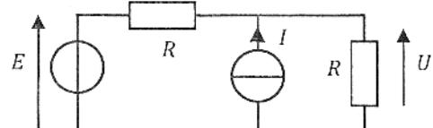
10. Un générateur de tension  $E$  en série avec une résistance  $R$  est équivalent à un générateur de courant  $I$  en parallèle avec une résistance  $r$  si :
