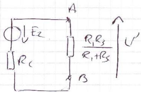
$$U' = \frac{\frac{R_1 R_3}{R_1 + R_3}}{\frac{R_1 R_3}{R_1 + R_3} + R_2} E_2$$
