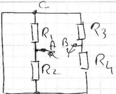
$R_{eq}$  mesuré depuis A et B : On imagine que le courant arrive par A et repart par B.
