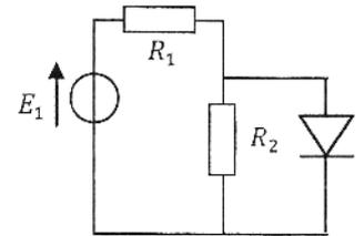
1. Si  $R_1 = 10k\Omega$ ,  $R_2 = 10\Omega$  et  $E = 10V$ , montrer que la diode est bloquée. Quelle est alors l'intensité du courant qui traverse  $R_2$  ?
