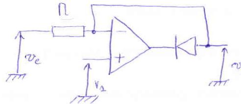
$$\text{cas 2: } V_{\text{out}} = V_{\text{SAT}}, \quad \varepsilon > 0$$
