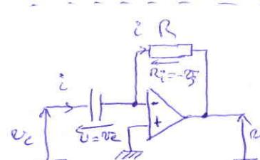
$A(\omega) = R j \omega C \xrightarrow{\omega \gg 0} 0$   $\Rightarrow$  Filtre passe-bas.
