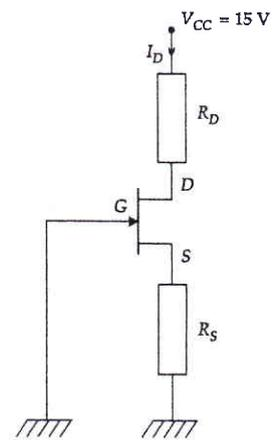
**Q4.** A quelle condition le transistor est-il polarisé dans sa zone linéaire?
